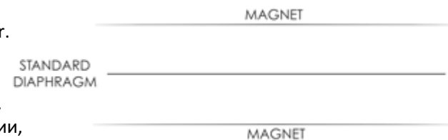
Рисунок 1: Работа обычного планарного излучателя
